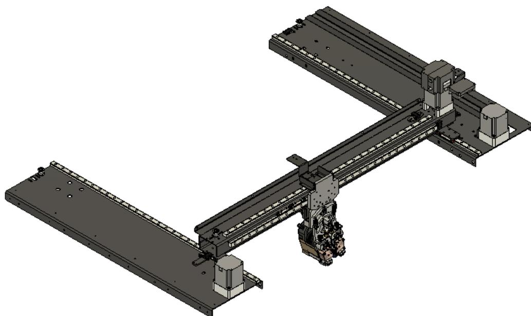
На оси Z стоит четыре двигателя размера NEMA17, которые приводят в движение 4 ШВП (1204). Движение шаговых двигателей синхронизированы на программном уровне. Подогреваемый стол передвигается по оси Z по 4 рельсовым направляющим бренда HIWIN 15 мм. Все направляющие и приводы находятся внутри прогреваемой зоны. Что обуславливает ограничение на максимальную температуру термокамеры.
