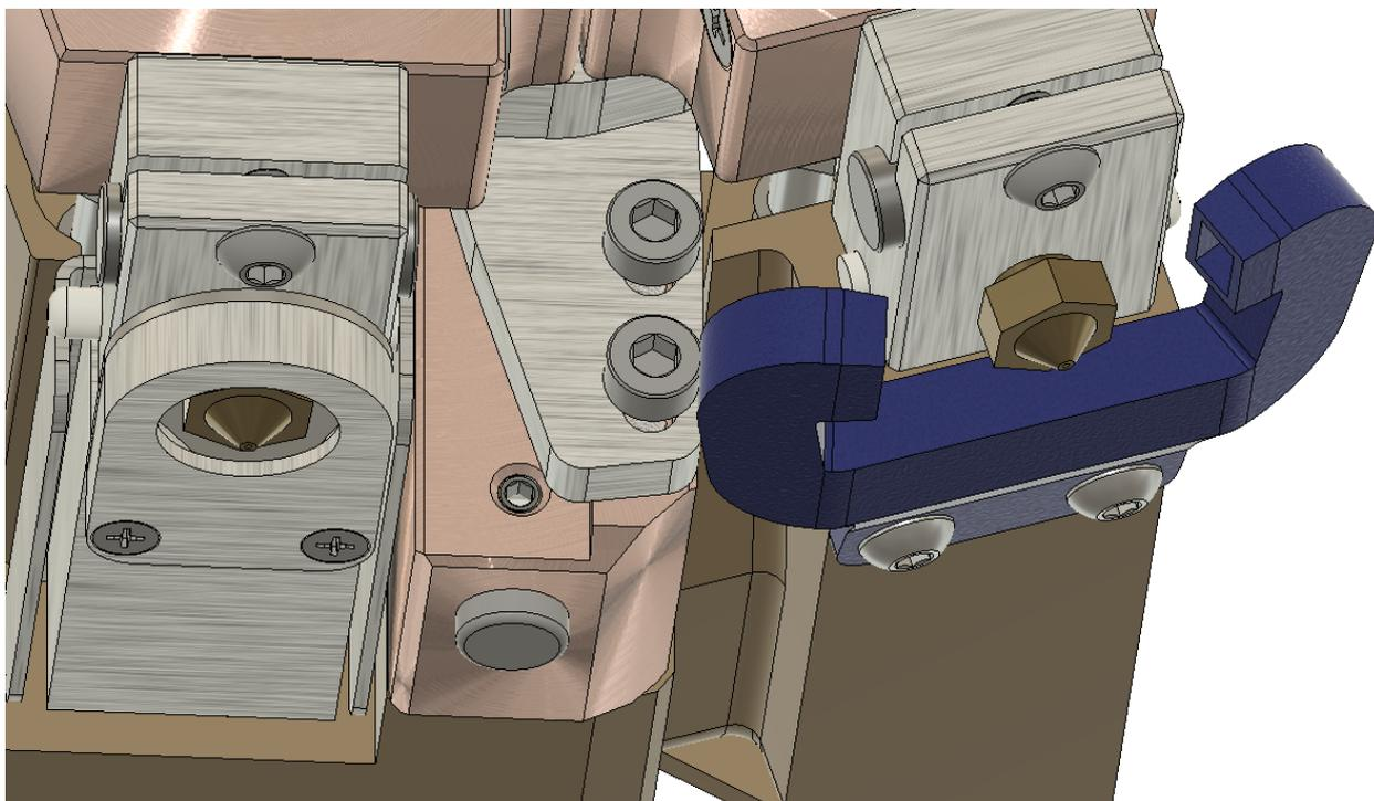
**Калибровка стола:** Автоматическая. Осуществляется с помощью индукционного датчика, причем сам датчик теплоизолирован и имеет собственный блок охлаждения.
