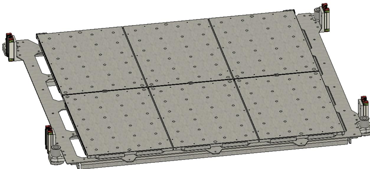
Стол состоит из шести фрезерованных сегментов размерами 200x300 мм, из специального сплава. В них вклеены высокотемпературные магниты. К каждой пластине крепится миканитовый нагреватель мощностью 500 Вт. Поверх этих сегментов укладывается подложка из нержавеющей стали марки AISI 430 толщиной 2 мм.
